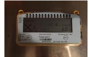
Rilevazione continua della temperatura con registrazioni ogni minuto per 60 giorni → non è dotato di un allarme e pertanto va consultato ogni giorno.
